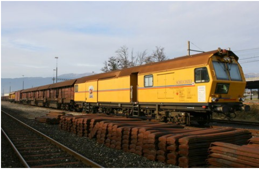
Train meuleur de rails (Scheuchzer S.A.)
