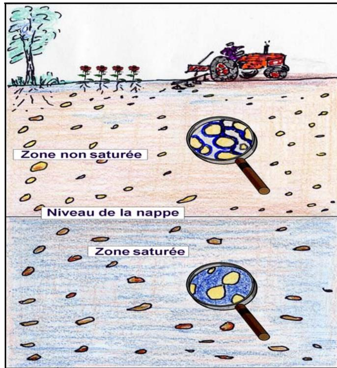
Illustration 31 - Zone saturée et non saturée dans un aquifère
