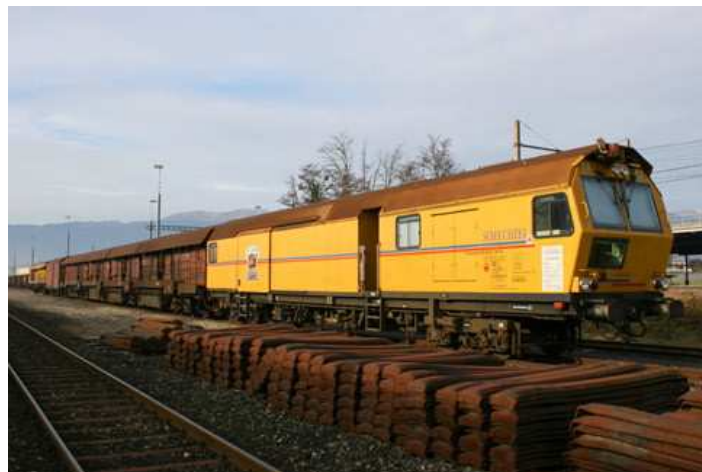
Train meuleur de rails (Scheuchzer S.A.)
